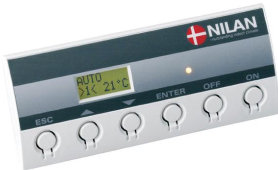
Comfort 1200 est commandé par le biais d'un boîtier de commande CTS 602 livré avec l'appareil. La commande propose de nombreuses fonctions via une interface à menus tel que la programmation hebdomadaire, le paramétrage de la périodicité de maintenance, le réglage de la vitesse de ventilation, la fonction bypass pour l'été (« free cooling »), la configuration du chauffage additionnel, le journal des alarmes, etc.
