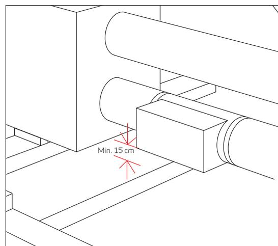
Batterie de pré-chauffage et sa sonde de température
